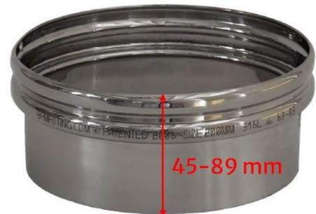
**BFM® Verbindungen** sind in Standardlängen ab 100 mm und darüber hinaus in 50 mm Schritten verfügbar. Die Einbauhöhe ist immer etwas kürzer als die Verbindungslänge (rd. 10 mm) zu planen, so dass die Verbindung im Einbau leicht gestaucht ist. Diese Stauchung sorgt für einwandfreie Funktionsfähigkeit der Dichtung, leichtes Handling beim Ein- und Ausbau und geringen Verschleiß.
