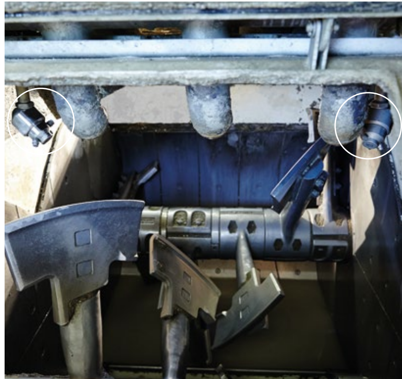
Doppelwellenmischer vor und nach der Reinigung
